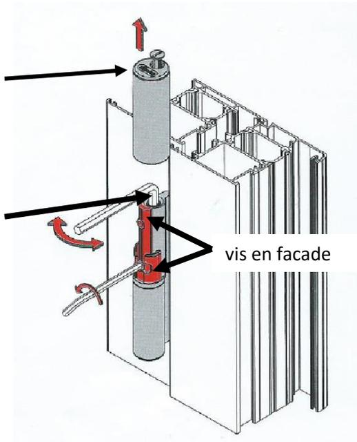
c) Ajustement de la compression côté poignée:
