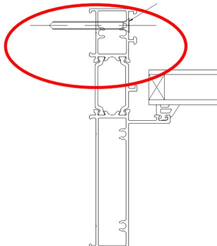
3. Installer les parcloles retirées en s'assurant de clipper le crochet extérieur en premier.
