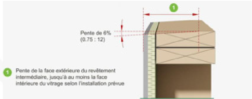
L'ouverture de la fenêtre ou de la porte doit subir une préparation afin qu'elle puisse recevoir, recueillir et diriger vers l'extérieur l'eau qui pourrait s'infiltrer par l'appui de la fenêtre ou le seuil de la porte ou qui pourrait s'accumuler sur la traverse de tête et s'écouler le long du jambage.
