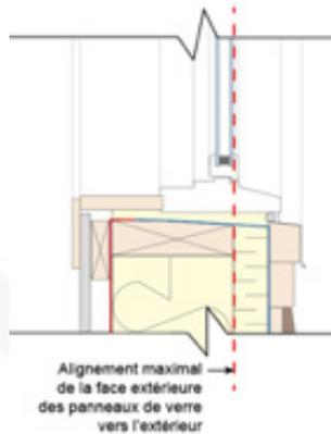
Il doit y avoir un isolant d'une résistance thermique minimale de RSI 0,70 devant l'axe extérieur du thermos.
